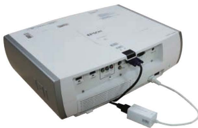
Sny-Trigger قابلیت روشن و خاموش شدن همزمان برده با پروژکتور (که به صورت جداگانه به فروش می‌رسد)
